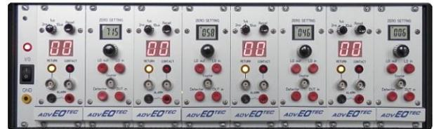
Configuration modules électriques MCE1 et optiques MCO1
