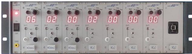
Configuration modules électriques MCROhms2/MCE2 et module de communication MCP2
