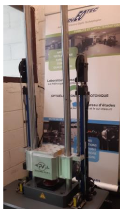
Essais en chocs sur composant optoélectronique
